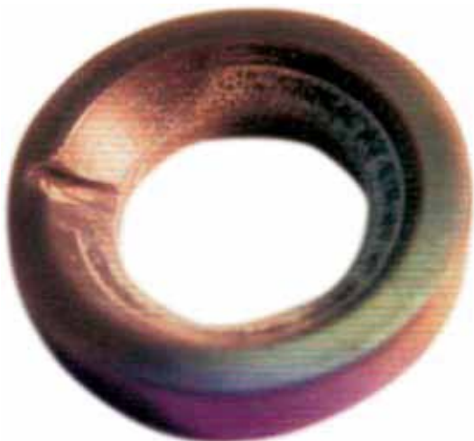
Ungeschützte Kugeldichtung mit Erosionskerbe Unprotected ball seat with erosion groove
